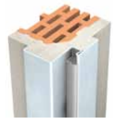
Profil 22 BRMB = dlb + 50 mm BRMH = dlh + 25 mm
